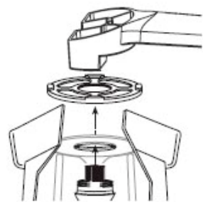
Монтаж фиксирующей гайки с помощью ключа
