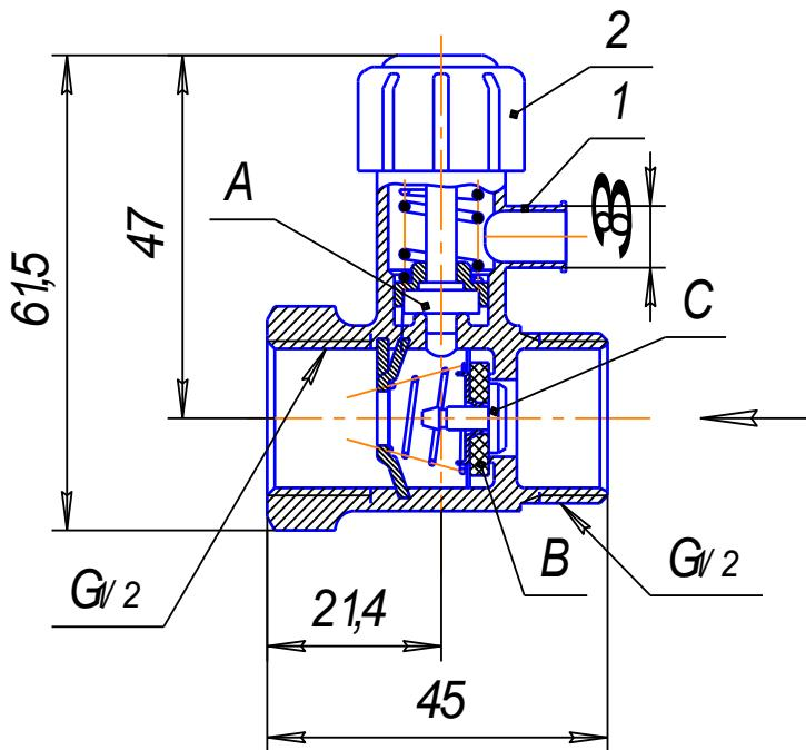
А- клапан предохранительный; В- клапан обратный; С- клапан перелива;
