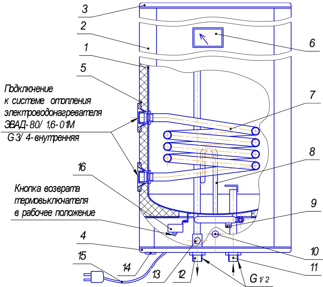
1 - резервуар; 2 - кожух; 3,4 - крышки; 5 - теплоизоляция;
