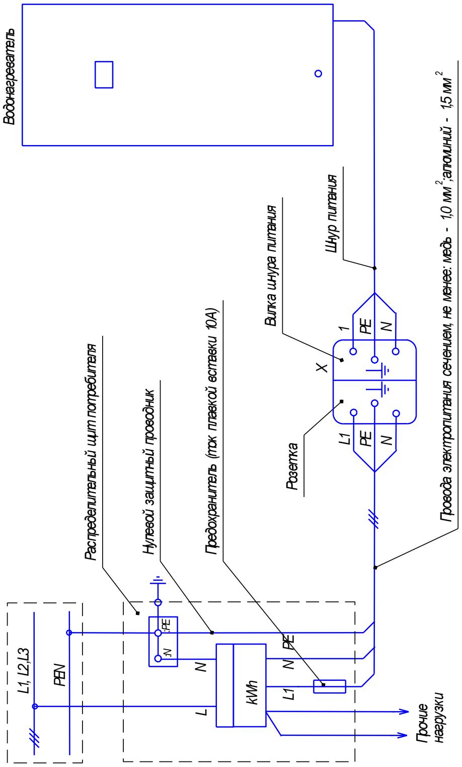
Рисунок 6 - Схема подключения водонагревателя к электросети
