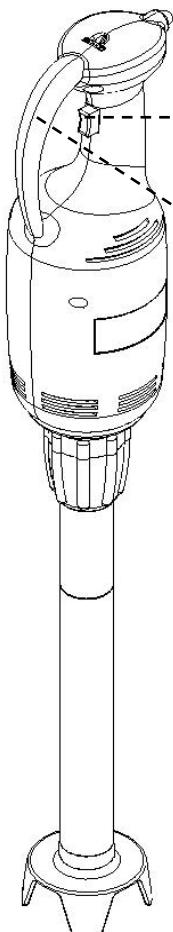
**Кнопка пуска (должна удерживаться в нажатом положении):** при отпускании кнопки подача электроэнергии на прибор прекращается, прибор выключается, и насадка останавливается.
